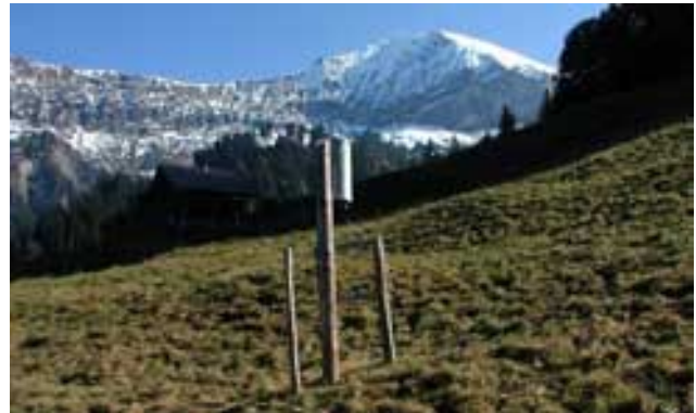
Fig. 2-4: Pluviometer (Monatstotalisator nach Hellmann) auf der Alp Gibel (BE), Wildbach-Testgebiet Leissigen des Geographischen Instituts der Universität Bern.
