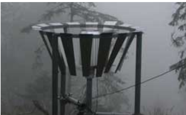
Fig. 2-7: Pluviograph (Waage, Ott pluvio 250) mit Windschutzvorrichtung im forsthydrologischen Testgebiet Sperbelgraben (BE) der WSL und des Geographischen Instituts der Universität Bern.
