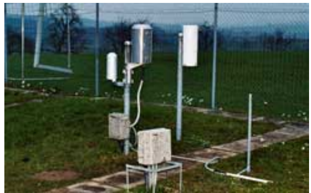
Fig. 2-5: Niederschlagsmessgeräte der ANETZ-Station Rünenberg (BL). Mitte: Pluviograph (Wippe nach Joss-Tognini), rechts: Pluviometer (nach Hellmann).
