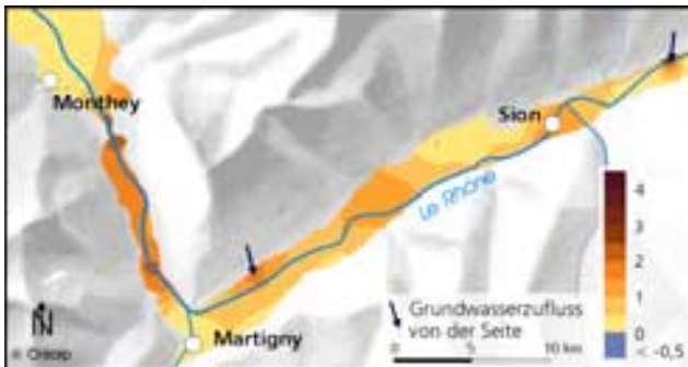
Fig. 7-27: Hochwasserereignis vom Oktober 2000 im Rhonetal: Ausschnitt aus der Karte der maximalen Amplitude des Grundwasserstandes, am 16.10.2000 (nach FAGERLUND 2001).
